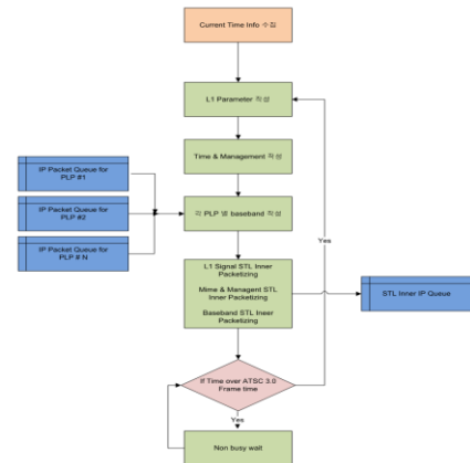
[그림 4] STLTP에서의 BB 프레임 패킷, L1 시그널링 패킷, 타이밍 정보 패킷 실는 과정
