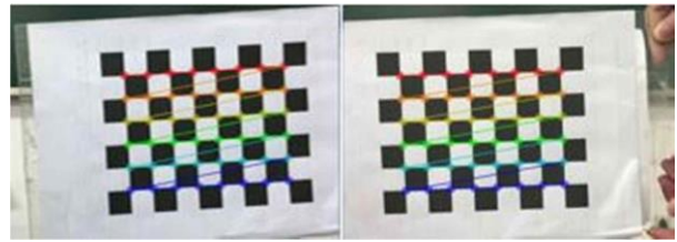
(a) Left Image (b) Right Image 그림 4 체스 보드를 이용한 카메라 캘리브레이션
