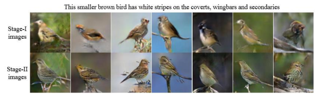
그림 7. 텍스트를 입력으로 받아 영상을 생성하고 GAN 을 한층 더 쌓아 해상도와 출력 영상의 품질을 향상시킨 StackGAN 의 예 [12]
