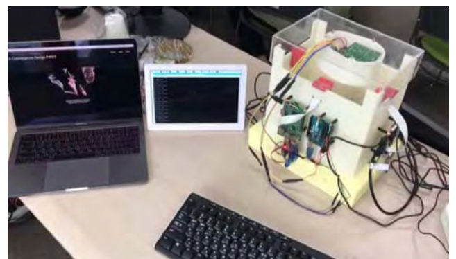
(그림 7) 실내 흡연감지 시스템 프로토타입
