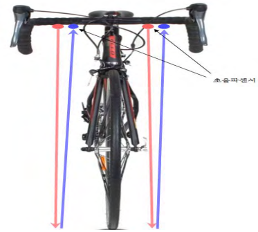
(그림2) 초음파 센서 부착 위치
