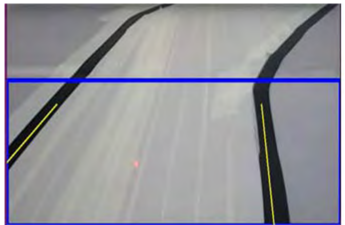
[그림 8 OpenCV를 이용한 차선 인식 결과]
