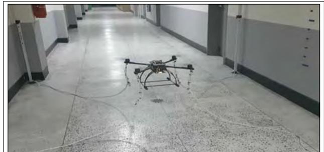
(그림 13) 위치홀딩 Test-bed
