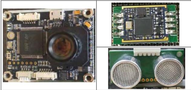
(그림 4) Optical Flow, AHRS, Ultrasonic 센서
