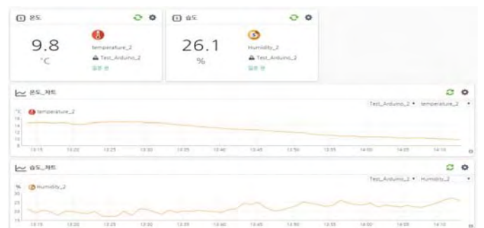
<그림 8> I2C 방식 시리얼 모니터 온도·습도 데이터 값 출력
