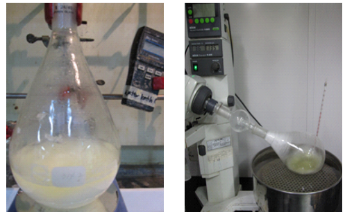
그림 8. 좌 : 2-propanol 부가공정 / 우 : 2차 증류 공정
