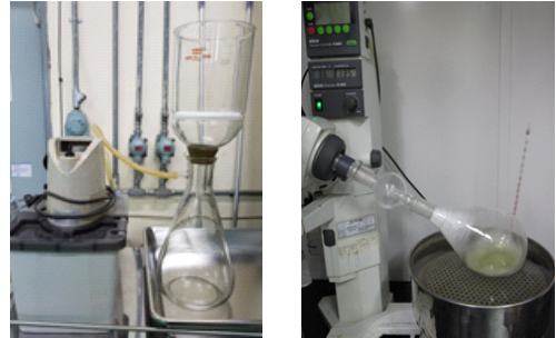
그림 7. 좌 : 여과 장치 / 우 : 1차 증류 공정
