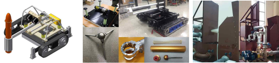
(a) 제품 개발 3D 개념도 (b) 개발 제작된 시제품 (c) 압력 봉쇄 성능 시험 장치 그림 1 외부투입형 선박 파공 봉쇄장치 및 성능시험장치
