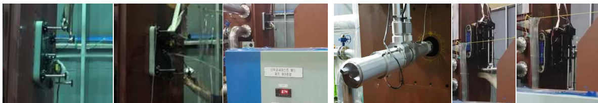
(a) 봉쇄패드 성능 시험 (b) 외부투입형 선박파공 봉쇄장치 통합 성능 시험 그림 2 외부투입형 선박 파공 봉쇄장치 성능 시험
