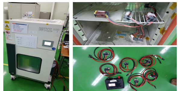
그림 3 배터리팩의 저온 방전 실험(-32°C)세트
