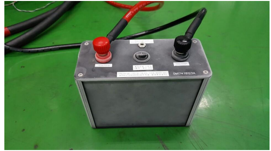
그림 5 20R셀 16개의 직병렬조합 기반 배터리팩(4S4P)
