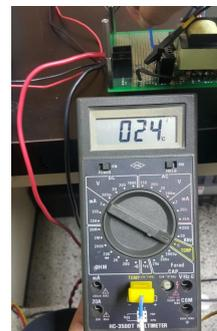
그림 7 MOSFET 케이스 온도 측정
