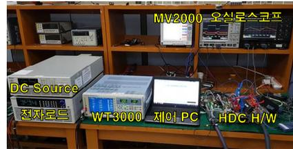
그림 6 HDC 효율 측정을 위한 실험 환경
