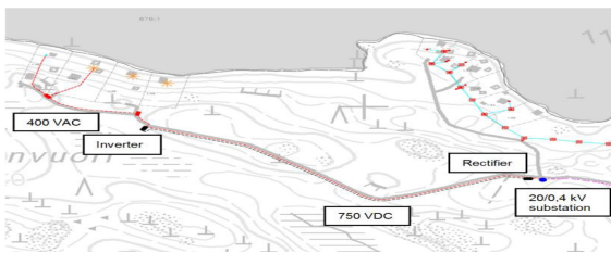
자료: Tomi HKALA, "LVDC Pilot Implementation in Public Distribution Network", p.2 2015.06 그림 1. 핀란드 LVDC 실증 필드 Fig. 1. Field implementation setup of Finland LVDC
