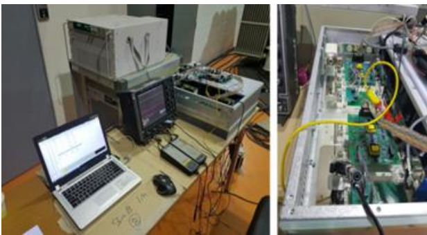
그림 3. 고압 파워스택 시작품 및 실험 셋업
