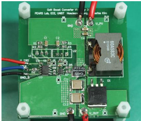
그림 3 제작된 GaN 부스트 컨버터 (5.9cm x 6.1cm) Fig. 3 GaN boost converter PCB circuit (5.9cm x 6.1cm)
