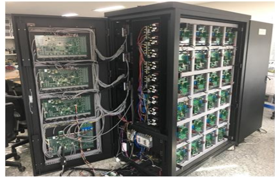
그림 4 5-레벨 MMC 시스템 실험 세트
