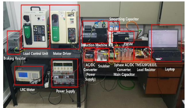
그림 10 PMSM 에너지 회수 최대화 연구를 위한 M-G set 실험 구성 Fig. 10 M-G set experiment configuration for PMSM energy recovery maximization study
