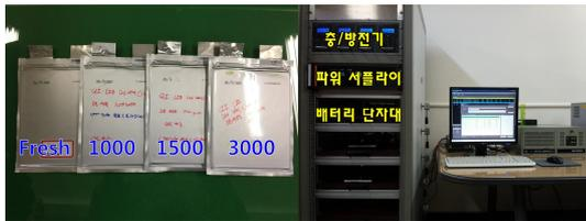
그림 4 배터리 (a)노화별 셀과 (b)충/방전 장비
