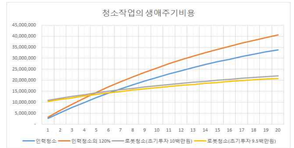
그림 2. 수작업 및 로봇작업의 생애주기비용
