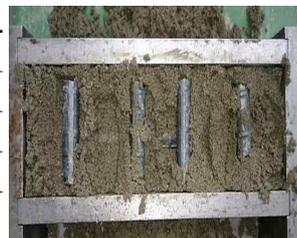
그림 1. 철근 설치
