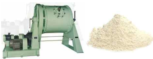
그림 1. 볼밀(좌) 및 가공 굴 패각 분말(우)
