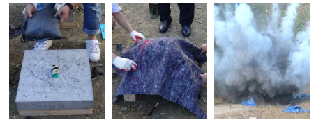
(a) TNT 및 모래주머니 설치 (b) 보호덮개 설치 (c) 폭파 모습
