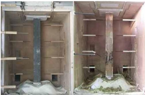
그림 2. 기둥부재의 내화시험 전·후 전경
