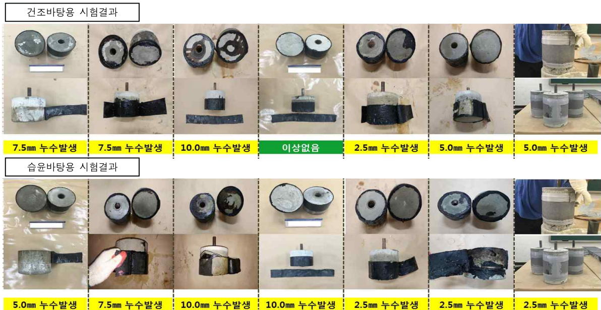
그림 1. 거동대응성 시험장치 제작 및 시험평가 현황
