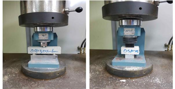
그림 2. 휨 강도 및 압축 강도 측정
