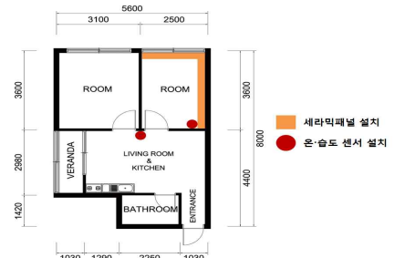
그림 3. 세라믹패널 및 온·습도 센서 설치위치
