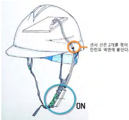
(그림 4) 안전모 턱 끈 도어락 센서
