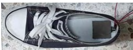
(그림 5) 센서가 부착된 깔창을 신발에 고정한 모습
