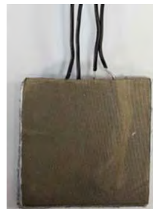
(그림 3) 5 cm×5 cm 사이즈의 차동 용량형 섬유 압력 센서
