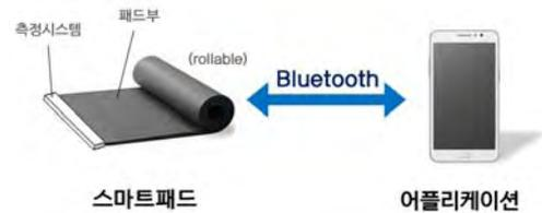
(그림 1) 제안한 스마트패드 시스템 개요도
