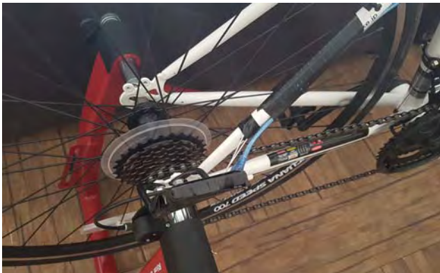
〈그림2〉 뒷바퀴에 부착한 Reed switch sensor
