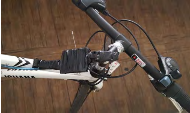
〈그림1〉 Rotary sensor가 부착된 핸들
