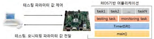
그림 2. 테스트와 모니터링을 위한 RIOS 기반의 어플리케이션 구조
