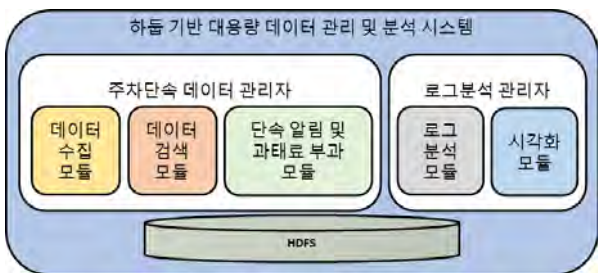
(그림 1) 하둡 기반 대용량 데이터 관리 및 분석 시스템 구조
