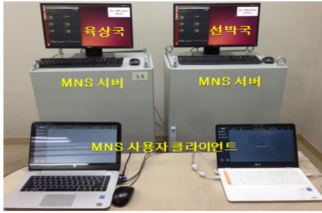
그림 4. 개발된 MNSS 실내 시험 검증 환경
