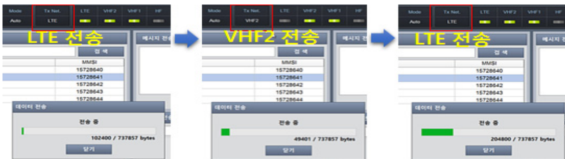
그림 5. 데이터 전송 중 통신대역(LTE ->VHF2->LTE) 전환 기능검증 결과
