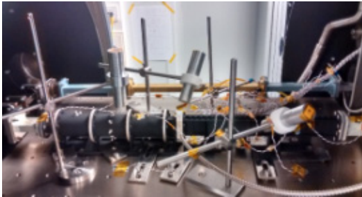
그림 3. 열진공챔버 내부 시험구성도
