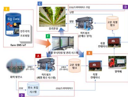
그림 2. 폐열활용 열공급을 위한 EMS 용 모델[6]
