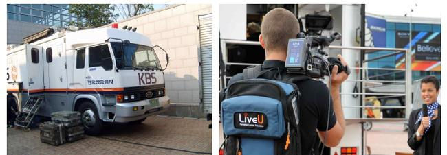
그림 2. 실시간 현장 중계 시스템. 중계차(왼쪽)와 MNG(오른쪽) 시스템.
