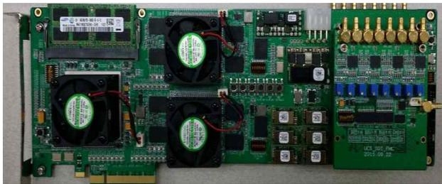
그림 1. FPGA 기반 멀티채널 UHD 영상 실시간 획득/재생 플랫폼
