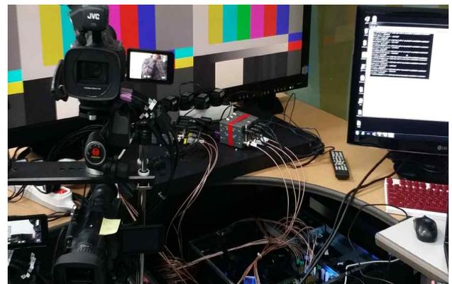
그림 4. 시험 환경: 4K 카메라 2대, 4K 디스플레이 및 서버
