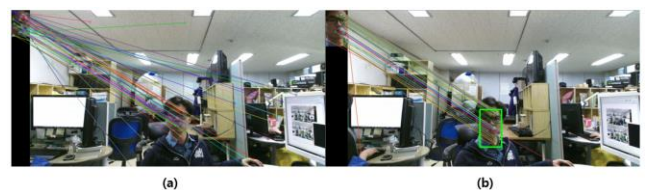
그림 2. (a) 여러 템플릿들과의 특징점 매칭 결과 (b) 호모그래피 변환으로 다시 찾은 추적 객체
