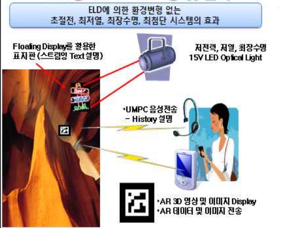
그림 5. ELD와 UMPC(음성전송) 적용 동굴의 조명과 함몰시 응급방송시스템 모델
