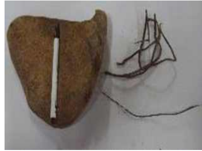
그림 2 지반하부의 돌망태확인 시료채취
