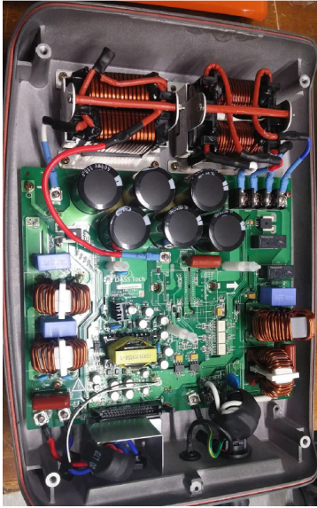
그림 3 인버터 내부 Fig. 3 Inside of Inverter
