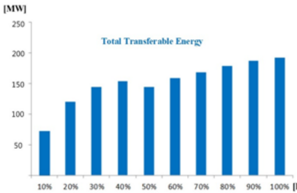
그림 4. 해당 DOD에 따른 총 운용가능 에너지량 Fig.3 Total transferable energy considering the DOD
