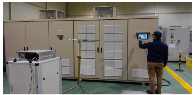
그림 7 개발된 11,000V/1,000kVA 고압인버터
