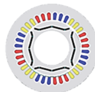
그림 1. 26kW 빌트인 스피들 모터 및 설계사양 Fig. 1. 26kW Built-in spindle motor and design specification
