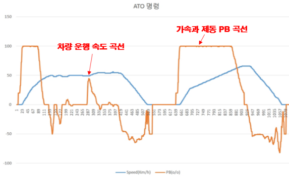
그림 2 차량의 ATO 운행 속도 패턴 Fig. 2 ATO driving speed pattern
