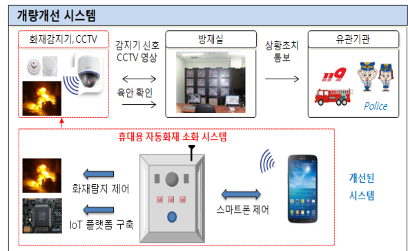
그림 1 제안한 이동형 화재 방재시스템 블록도
