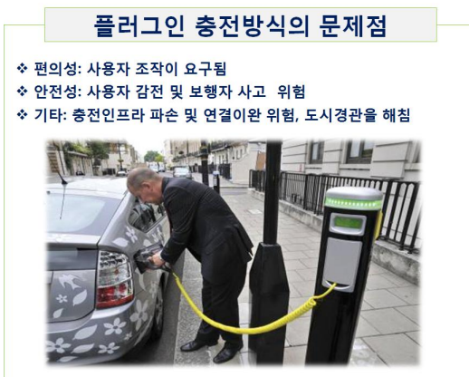
그림 1 플러그인 충전방식의 문제점 Fig. 1 Potential problems of plugin-charging
