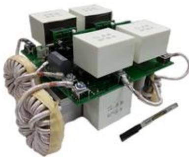
그림 3 제안하는 양방향 컨버터 2kW급 시작품
