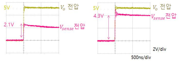
그림 5. 분리 시( C_{12}=18pF )와 완전정렬 시( C_{12}=157pF ) V_{sense} 전압
